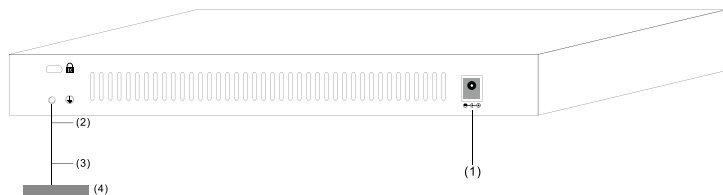
图 2-4 机房有接地排时接地安装简图
