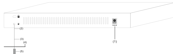
图 2-5 机房附近允许埋设接地体时接地安装简图
